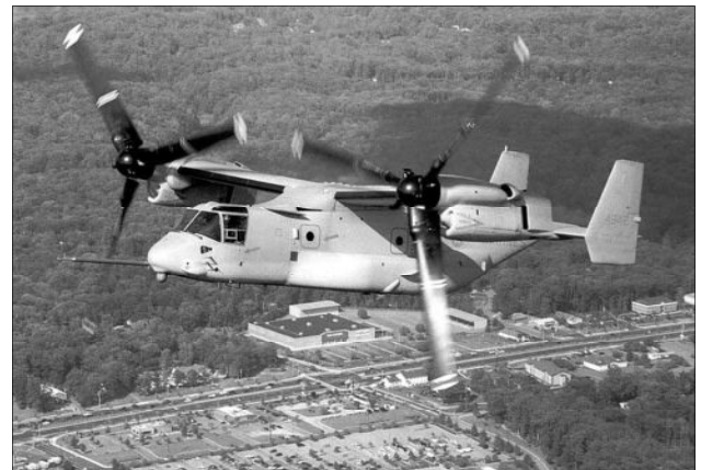
MV-22 オスプレイ。離着陸時はプロペラを上、航行時は前に向けます。(写真はウィキペディア・コモンズより)
