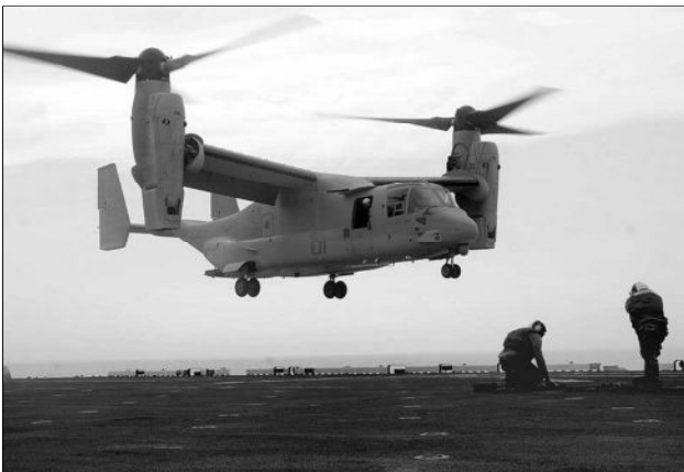
MV-22 オスプレイ。離着陸時はプロペラを上、航行時は前に向けます。(写真はウィキペディア・コモンズより)
